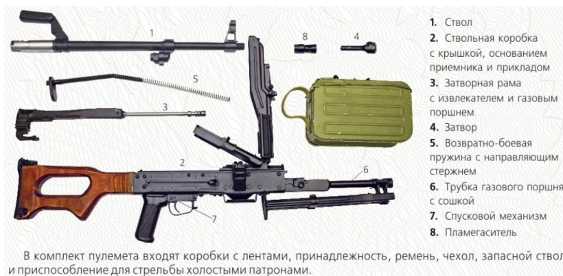
Рисунок 19 – Материальная часть 7,62 мм пулемёта Калашникова
