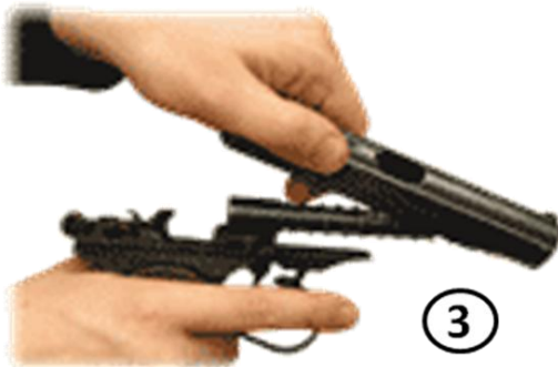
Рисунок 34 – Отделение возвратной пружины ПМ
