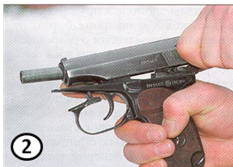
Рисунок 33 – Отделение затвора от рамки ПМ
