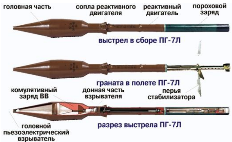
Рисунок 26 – Строение выстрела для гранатомёта РПГ7
