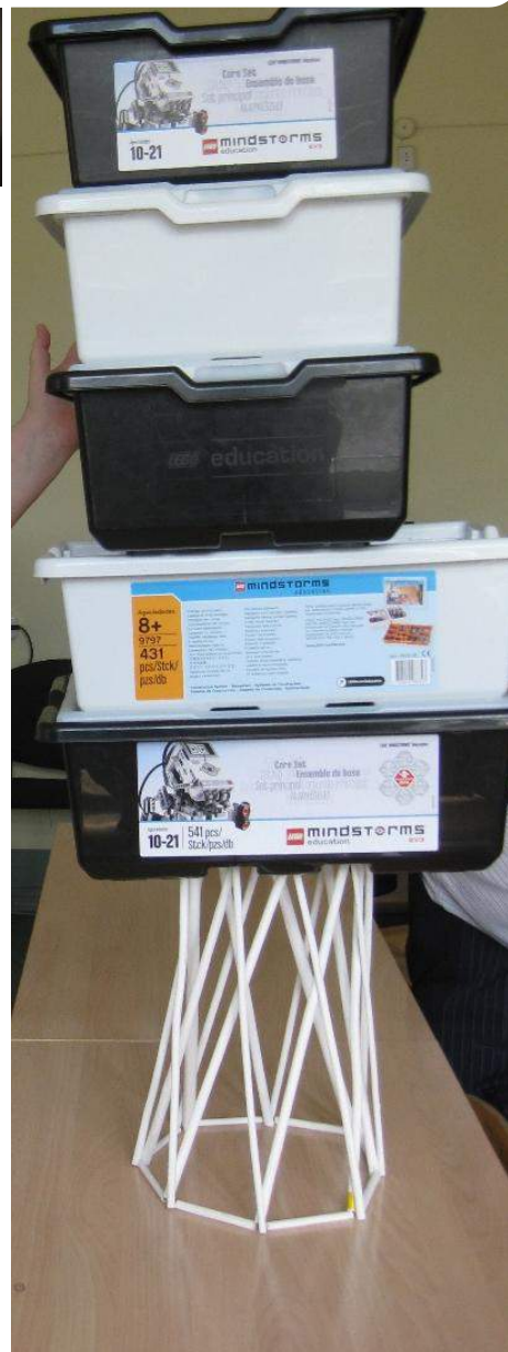
Reciprocal Frame / Ресипрокальные (самоопирающиеся) конструкции Тьютор: Курбатова Н.В., доцент кафедры АПЗС НГАСУ (Сибстрин)
